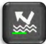
Il est nécessaire d'ajuster le niveau de suppression du clutter marin afin d'utiliser le radar avec précision. Si vous ne le faites pas, il est pas possible d'obtenir un écho radar précis.
