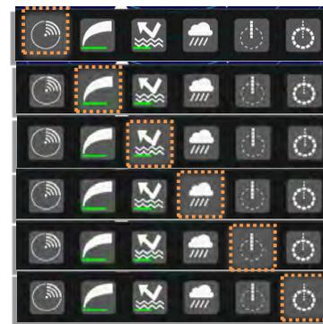
Appuyez sur l'icône TX/STBY, ou poussez le bouton rotatif lorsque l'icône TX/STBY est focalisée.
