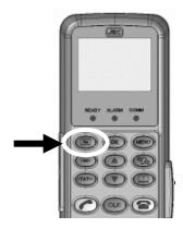
Fig. 7.2b To toggle the input mode
